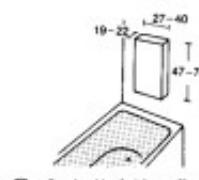
15 Gasdurchlauferhitzer für Schornstein
